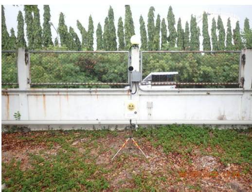
รูปที่ 27 การตรวจวัดระดับความดังของเสียงริมรั้วโรงงาน
